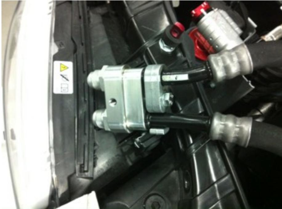
**6. Ölkühler rechte Seite (Beifahrerseite) und Schlauchleitungen am Ölkühleranschluss Unterseite montieren (rot-rot/grün-grün, siehe auch Bild 1).**
